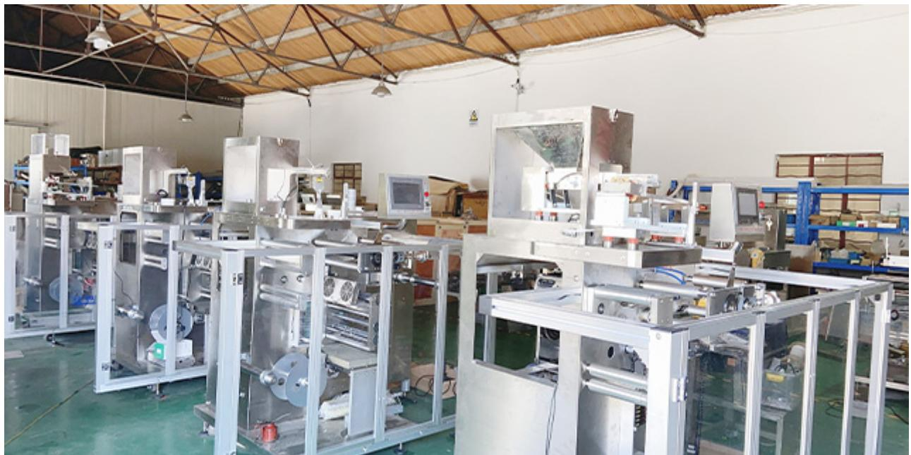
四边封自动包装机是根据市场需求专门为小型制药厂、医院药剂科、制药厂等设计的新型包装设备。以铝箔为包装材料的复合密封包装，该机结构紧凑、性能稳定、密封可靠、造型美观、自动化程度高、携带方便、安全维修方便，符合优良制造标准要求。胶囊/药片自动包装机主要应用在制药、化工、食品等行业产品中球状、圆片状物料的自动包装，使用于多种规格尺寸的胶囊、药片、素片等药片的包装，形状相近的小五金、电子元件或食品也可使用，如：药片、胶囊、颗粒、糖衣片等。采用液晶面板微电脑控制，可以自动完成纸袋的操作调整，减少人工调节，制袋精度高，误差小。
