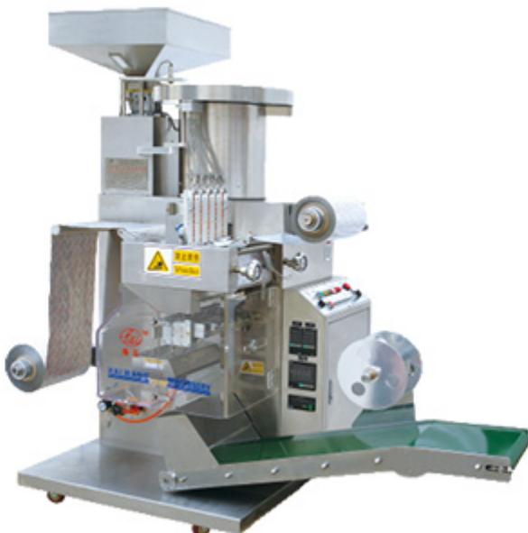
上海海王机械有限公司所产四边封包装机采用分段组合，可进行分体包装和运输。集机、电、气为一体，采用PLC程序编程控制，人机界面操作，伺服电机牵引。可在触摸屏上直接调节行程及供气时间。由PLC程序编程控制，分别完成加温预热、正压成形、自动加料、缺粒检测、光电对版、\*道热封、打批号、热带铝成形、第二道热封、压痕、伺服电机牵引、冲裁、自动剔废、废边收卷装置等全部工序。本产品适合生产铝塑、铝塑铝泡罩包装、一机多功能设备。重庆安全四边封包装机销售厂拥有近30年的专业技术团队，为您定制四边封包装机。
